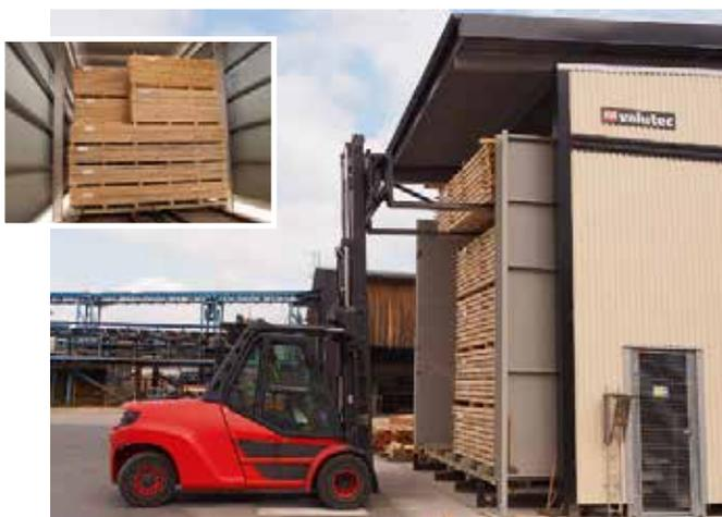
Übergabe von der Beschickung in die eigentliche Trocknereinheit: Im Kanaltrockner ist ab hier alles in Edelstahl ausgeführt
